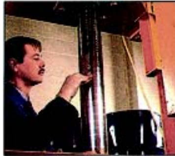
RECONSTRUCCION DE ARIETES RAYADOS
