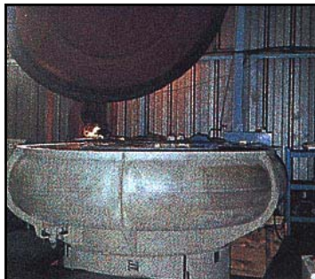
RECONSTRUCCION DE FORROS EN MAQUINARIA
